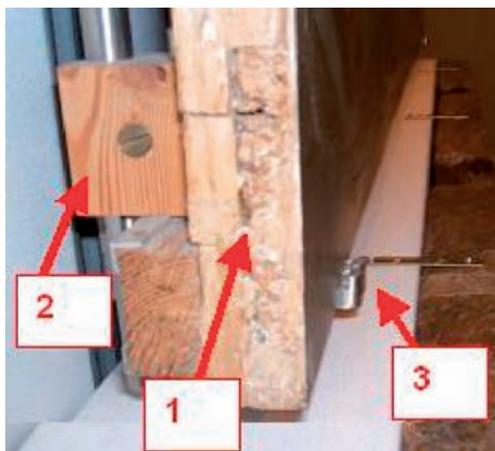
**Figura 14.** Vincolamento rigido di un dipinto su legno. Il dipinto (1) è vincolato posteriormente con morsetti su guida verticale regolabile (2) e anteriormente alla base con altri morsetti (3) chiodati su supporto fisso.
